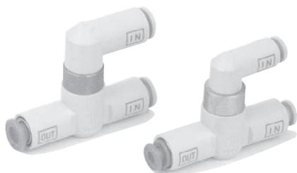
O ar fluirá para a saída somente quando a alimentação de ar for realizada em  $P_1$  e  $P_2$ . Quando a pressão nas entradas forem diferentes, a pressão de menor valor fluirá para a saída.
