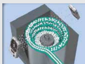
Neutralização estática em alimentadores de peças
